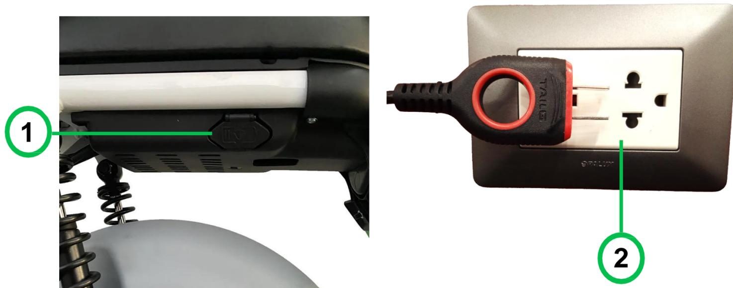
PASO 3: Al finalizar la carga luego de varias horas, el indicador (3) mostrará color verde. Primero desconectar el cargador del tomacorriente y luego del puerto de carga.
