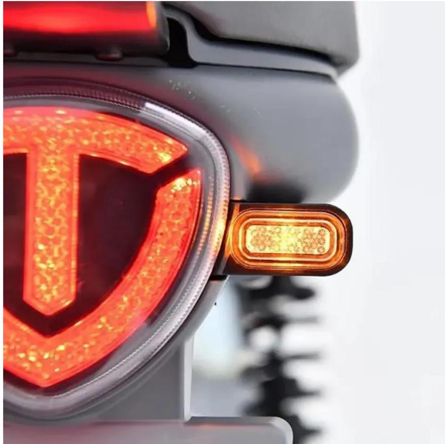
Luz de freno y luces direccionales traseras
